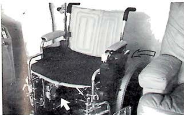
Silla eléctrica motorizada. En la parte inferior se encuentra el motor. En la parte posterior se adapta el ventilador y un cilindro de oxígeno "E". En el descanso-brazos izquierdo se encuentra la perilla de control; ésta controla velocidad y dirección y se encuentra de este lado ya que el paciente es zurdo.
